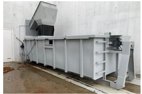
Figure 10 : Exemple d'une benne avec déchargement automatique (crédits : Lannion Trégor Communauté)
