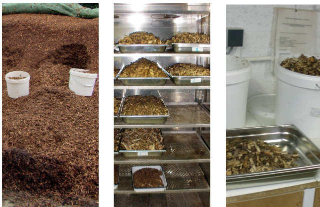
Échantillonnage sur plateforme - étuve - préparation en laboratoire - photos : ©AILE
